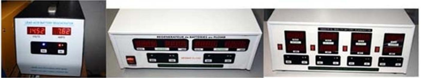
Les régénérateurs de batteries au plomb REGBAT envoient des pulsions positives et négatives pour désulfater la batterie et récupérer la capacité perdue.
