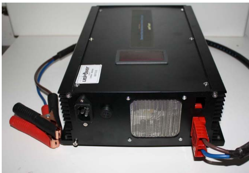
Aération du Chargeur-Désulfateur
