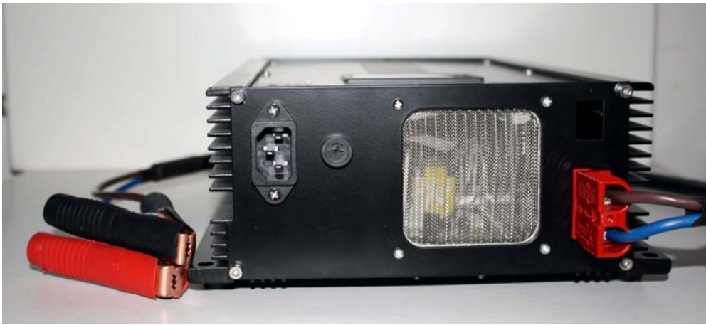
Arrière du Chargeur-Désulfateur
